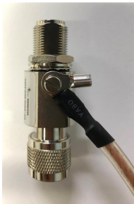
图 4-24 防雷器安装接地引线
