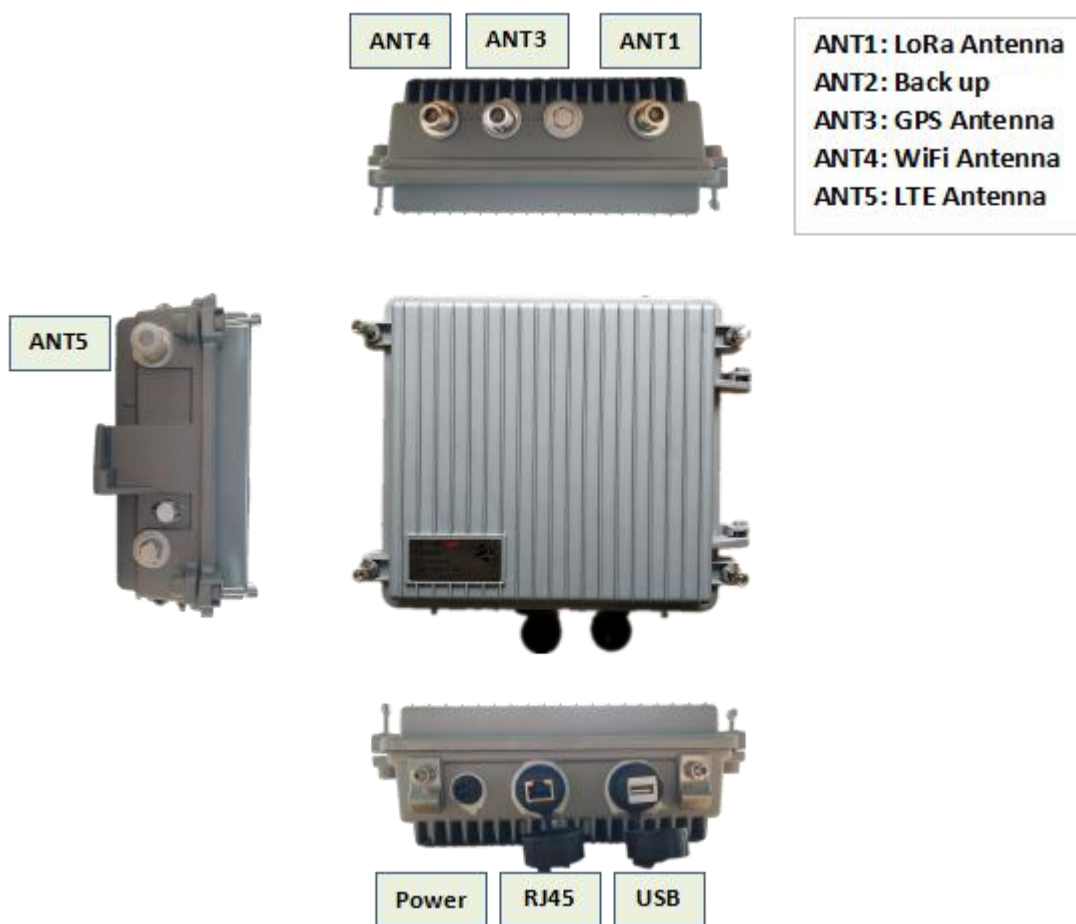
图 2-1 网关设备外部接口示意图
