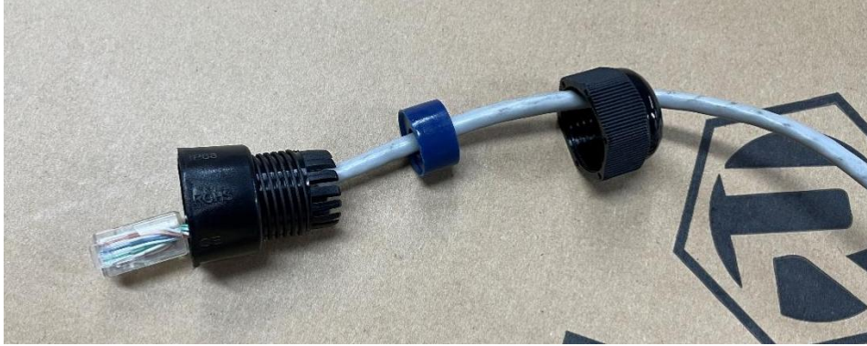
(c) 网线插入 RJ45 接口，通过旋紧防水帽将密封圈压紧
