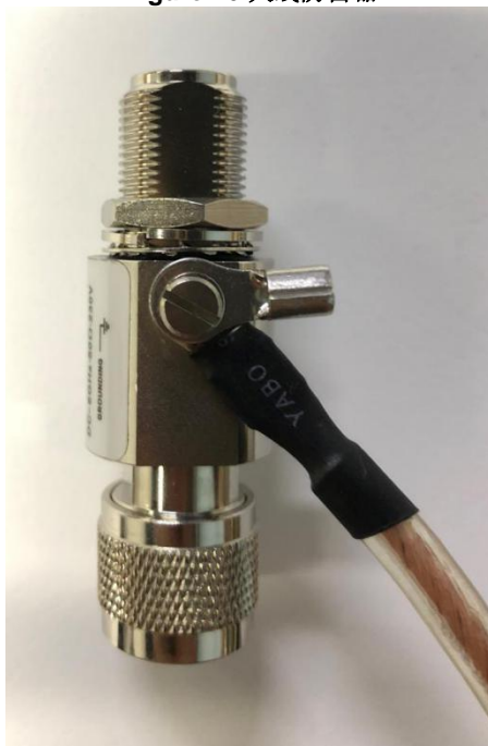
Figure 17 防雷器安装接地引线
