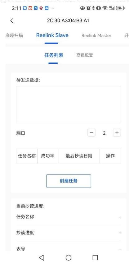
Reelink 是瑞兴恒方独有的实现 LoRa 设备之间独立通讯的技术，Reelink 允许设备在保持标准 LoRaWAN 的基础上，同时实现灵活的点对点通讯，广泛用于自动抄表，参数设置等使用。
