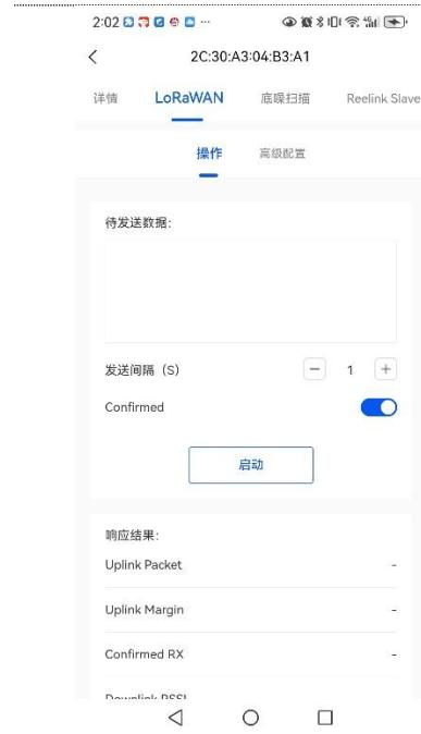
LoRaWAN 评估模式用于和模拟一个节点设备，和网关进行通讯测试和评估使用。
