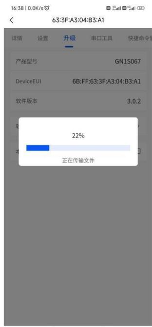
首先 APP 向设备发送升级固件，当进度条达到 100%后，设备将会断开蓝牙连接，断开连接后约 10 秒设备完成固件更新，蓝灯常亮 3 秒，此时 APP 可以再次搜索到设备并发起连接，连接成功后可以查看设备的软件版本号，确认升级成功。
