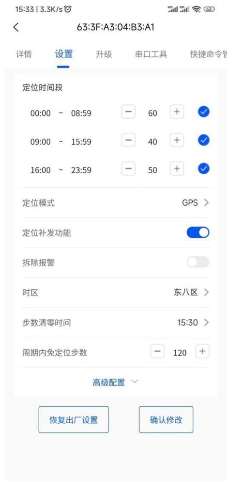
在本页中，用户可以灵活配置定位时间段、定位补发功能、时区、步数清零时间、免定位步数（也就是前文的定位豁免步数）。定位模式和拆除报警不用设置，预留给未来使用。
