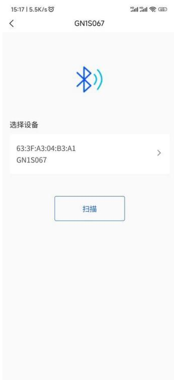
点击待连接的设备即可发起一次蓝牙连接，如果连接成功，则进入下一页面，并且设备的绿色指示灯将会闪烁，表示连接成功。
