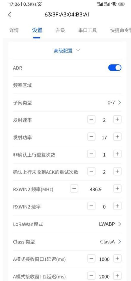
上图中的参数为 LoRaWAN 网络相关的参数，不熟悉 LoRaWAN 的用户请慎重修改，随意修改可能会导致设备失联。
